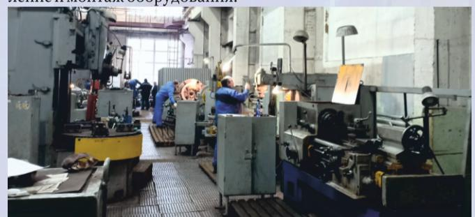
В структуре РММ находятся: участок по ремонту импортного оборудования, участок перемотки электродвигателей, участок по ремонту насосного оборудования, токарный участок и кузнец.
