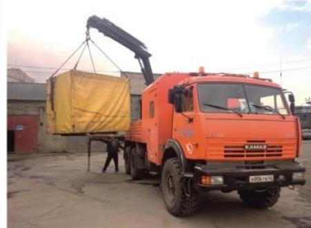
На фото: монтаж бентонитовой установки в кузов автомобиля.
