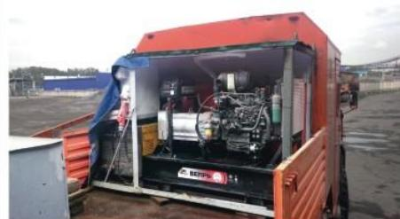
На фото: генератор в кузове автомобиля.
