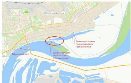
А работы объемные: сначала необходимо раскопать существующую дамбу, затем проложить железобетонную трубу общей длиной 54 метра, установить шиберную задвижку, обустроить камеру, и, наконец, восстановить дамбу.
